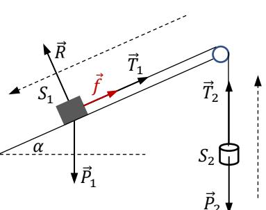
الجسم  $S_2$  :  $S_2 : S_2 = m_2 \vec{a} : \vec{P}_2 + \vec{T}_2 = m_2 a$  ، وباسقاط هذه العلاقة على المحور الشاقولي الموجه نحو الأعلى: لدينا  $T_2 = T_1$  ، لأن كتلة الكرة محملة. طوبينا تسارع الجسمين متساوين.
