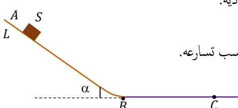
نعتبر الاحتكاك على المستوى المائل ( $L$ ) مكافئاً لقوة ثابتة شدتها  $f = 0,1 \text{ N}$  ، ولها حامل شعاع السرعة ومعاكسة له. نترك جسماً صلباً  $S$  كتنته  $m = 100 \text{ g}$  ينزل من النقطة  $A$  عند اللحظة  $t = 0$  على خط الميل الأعظم لمائل عن المستوى الأفقي بزاوية  $\alpha = 30^\circ$  . نحمل تأثير الهواء ونعتبر  $AB$  خطًا مستقيمًا، ونعتبر الجسم  $S$  نقطة مادية.
